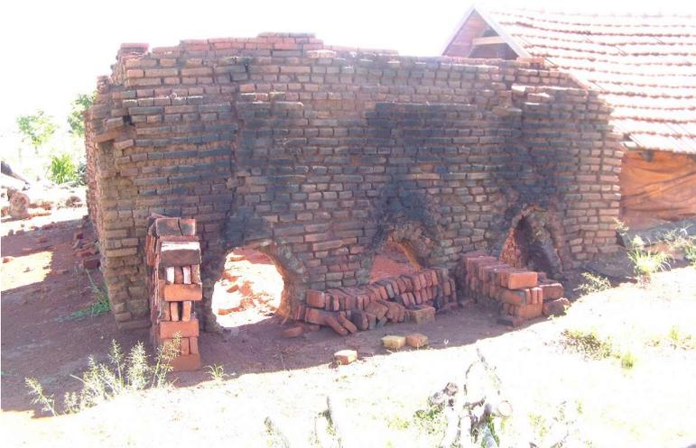
Schließlich werden sie im Brennofen aufgeschichtet und gebrannt. Dabei halten die Steine die Temperatur eine ganze Weile, da auch die in die Tonerde gemischten Sägespäne verbrennen. Gleichzeitig werden die Ladrillos dadurch leichter und poröser.
