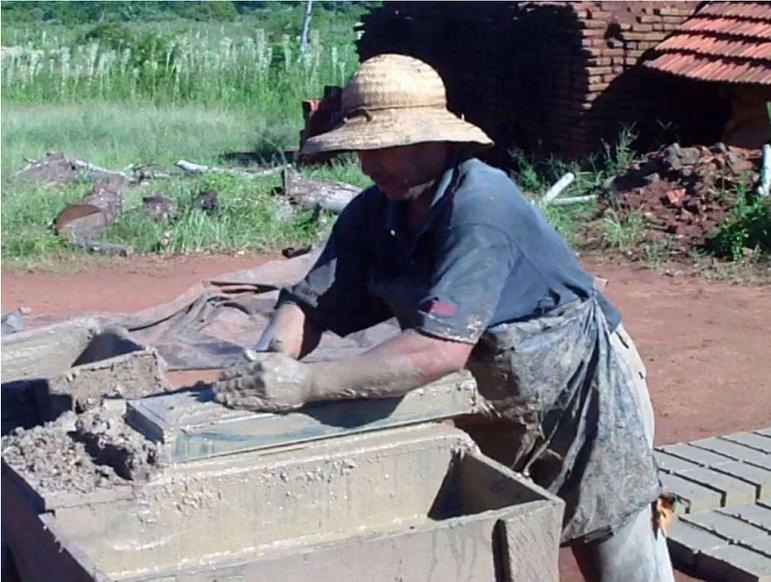
Die Ziegel-Rohmasse wird per Hand in eine Schablone gedrückt, in der 2 Steine geformt werden.
