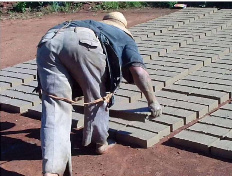
Die Ziegelsteine werden am Boden abgesetzt und durch die Sonne getrocknet. Dabei werden sie mehrmals umgestapelt und schließlich unter einem Dach regengeschützt luftgetrocknet.
