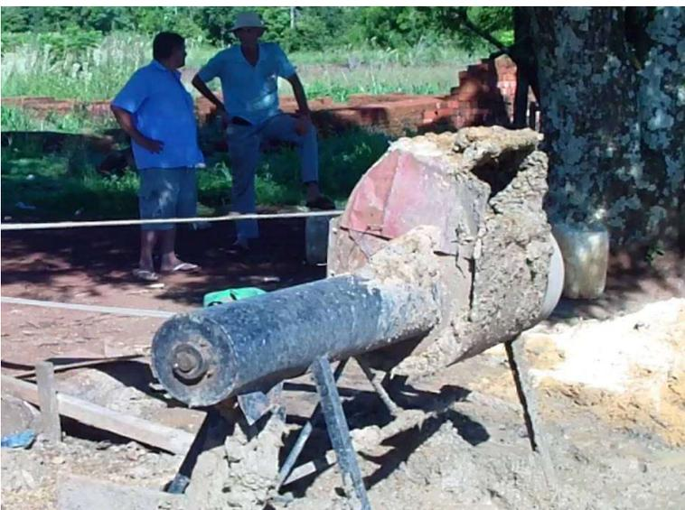
Das Gemisch wird in einen Zwangsmischer geschaufelt, der von einem stationären Diesel über einen Flachriemen angetrieben wird.
